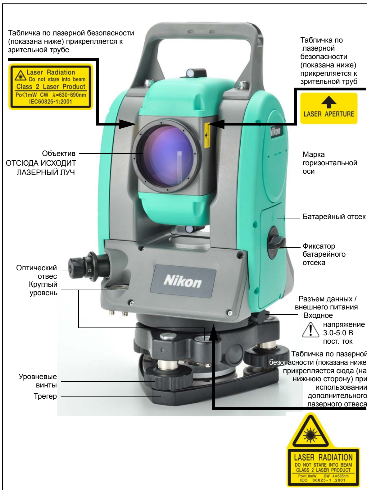
Рисунок 1.2 Электронный безотражательный тахеометр серии Nivo – Страница-2
